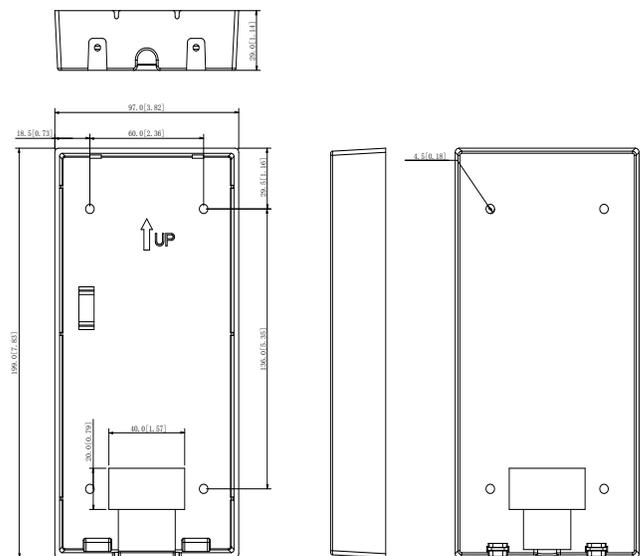
**Шаг 1.** Прodelайте отверстия для винтов в стене согласно положению винтовых отверстий в монтажной коробке, затем установите дюбель в винтовые отверстия.
