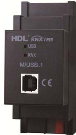
M/USB.1 это новый интерфейс шины KNX, гальванически изолированный USB, который обеспечивает двунаправленный обмен данными между ПК и шиной KNX. Устройство позволяет адресацию, установку параметров, визуализацию, протоколирование и диагностику устройств соединенных шиной. Коннектор USB и шина находятся в передней части устройства, вместе с желтыми LED. Индикаторы показывают статусы и трафик относящийся к шине и ПК.
