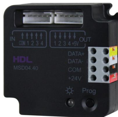
**HDL-MSD04.40** 4-канальный модуль входа сухих контактов с защитой от искажения, выходы на 4 LED.
