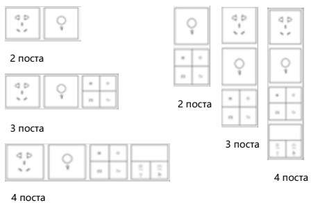
Рис 5. Горизонтальная установка Рис 6. Вертикальная установка
