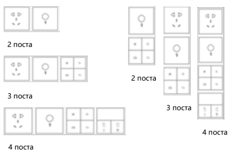
Рис 5. Горизонтальная установка Рис 6. Вертикальная установка
