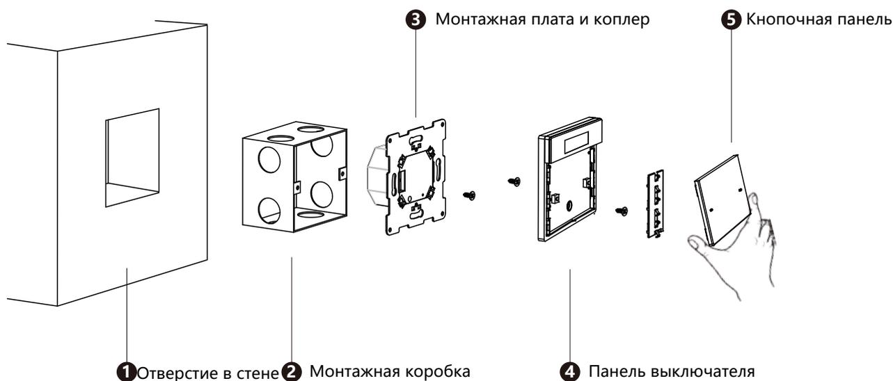
Примечание: если для панели выключателя требуется защита от воровства, используйте специальный винт. Процедура заключается в следующем: используйте тонкий пластиковый предмет для нажатия пружины сбоку панели. Снимите крышку из нержавеющей стали. Навинтите винт с круглой шляпкой М3 \* 8. Вставьте обратно крышку из нержавеющей стали, а затем вставьте обратно клавишу.
