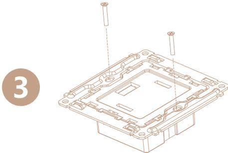
Закрепите панельный модуль и декоративную рамку вниз по очереди. Установка завершена, если панель работает нормально
