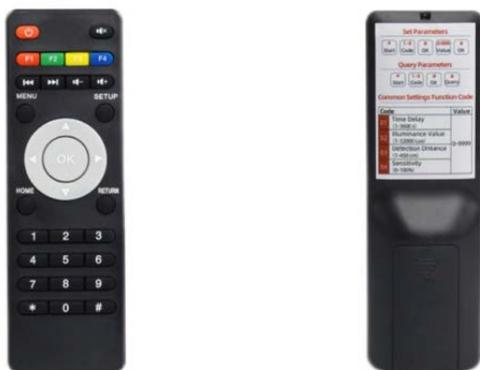
Рис. 5. Пульт-ДУ для настройки датчика
