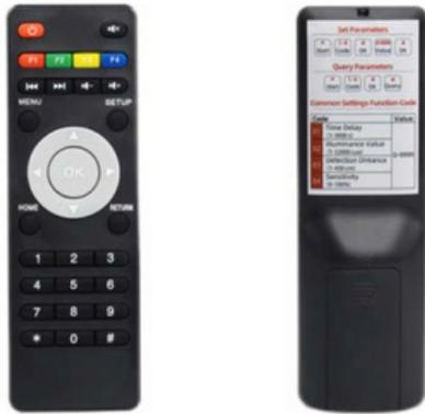
Рис.5. Пульт-ДУ для настройки датчика
