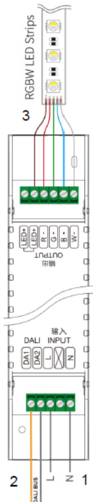
Рис.4. Схема проводки для подключения светодиодной ленты к шине DALI
