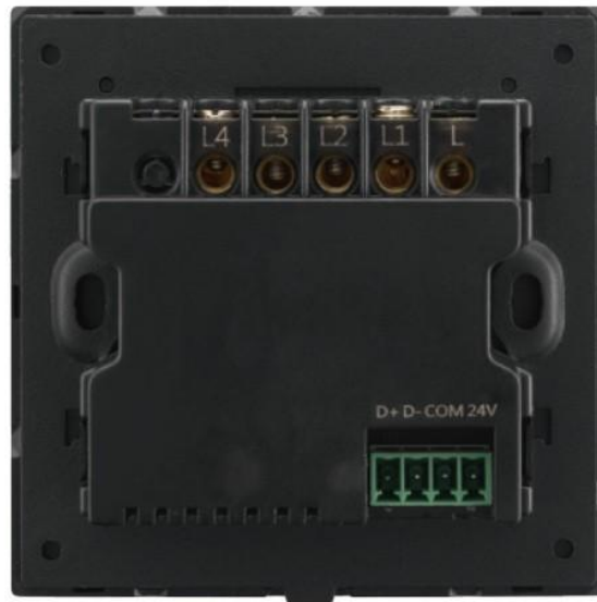
Интерфейс питания панели Buspro с реле
